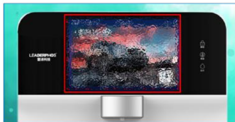
step3: 用户按住出水按钮后，切换净水器出水启动页，展示全屏轮播图或全屏视频15s
