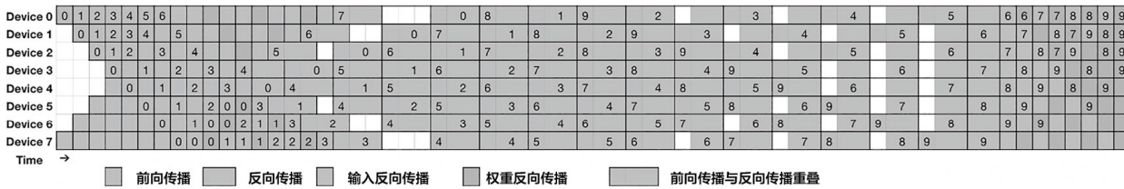
图2-4 基于DualPipe的双向流水线调度机制
