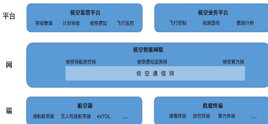
图 1 低空信息通信系统体系架构
