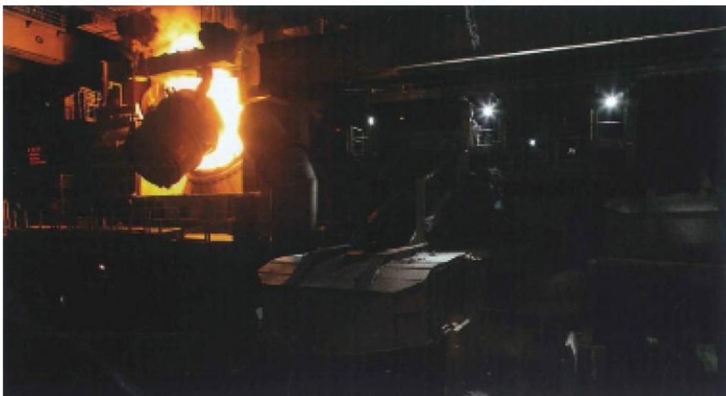
贝塞麦今天依然存在：2012 年蒂森克虏伯公司，将生铁倒入一个酸性转炉。
