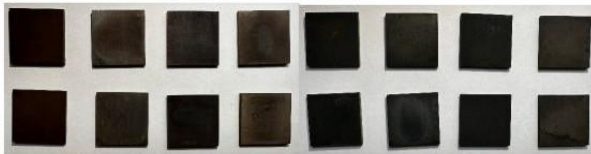
450° C H2 盐中 250-500-750-1000 小时腐蚀后金属表面(左侧 347H，右侧Q345R)
