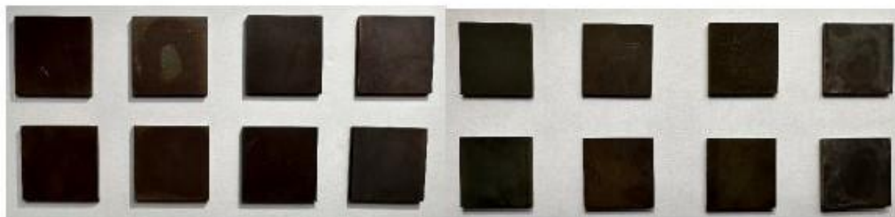
450° C H1 盐中 250-500-750-1000 小时腐蚀后金属表面(左侧 347H，右侧Q345R)
