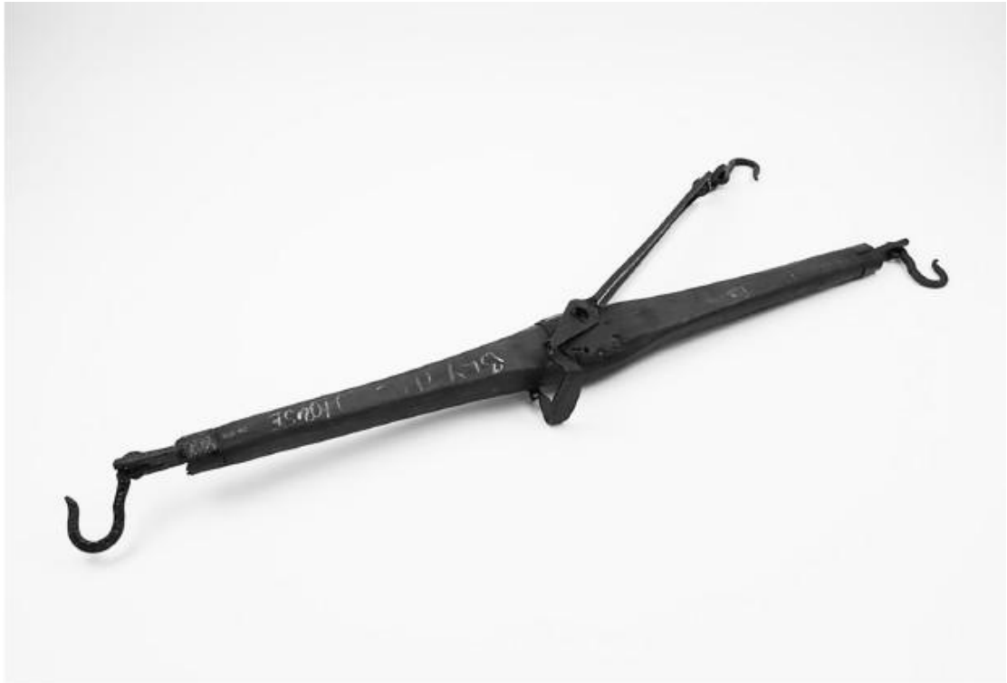
图 6-26 17 世纪苏格兰农民使用的简易天平
