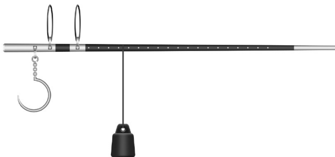
图 6-29 秤杆、秤砣以及秤杆上的秤星
