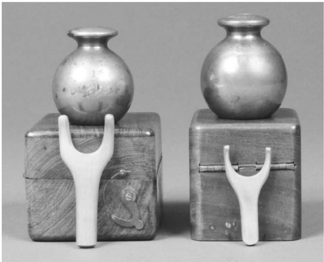
图 4-10 两件砝码，各重 1 磅，左为金衡磅，右为常衡磅（1830 年前后铸造于英国）
