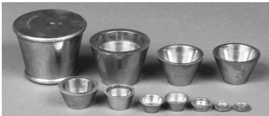
图 6-34 1852 年美国海岸与大地测量局在法国人指导下铸造的一套标准砝码
