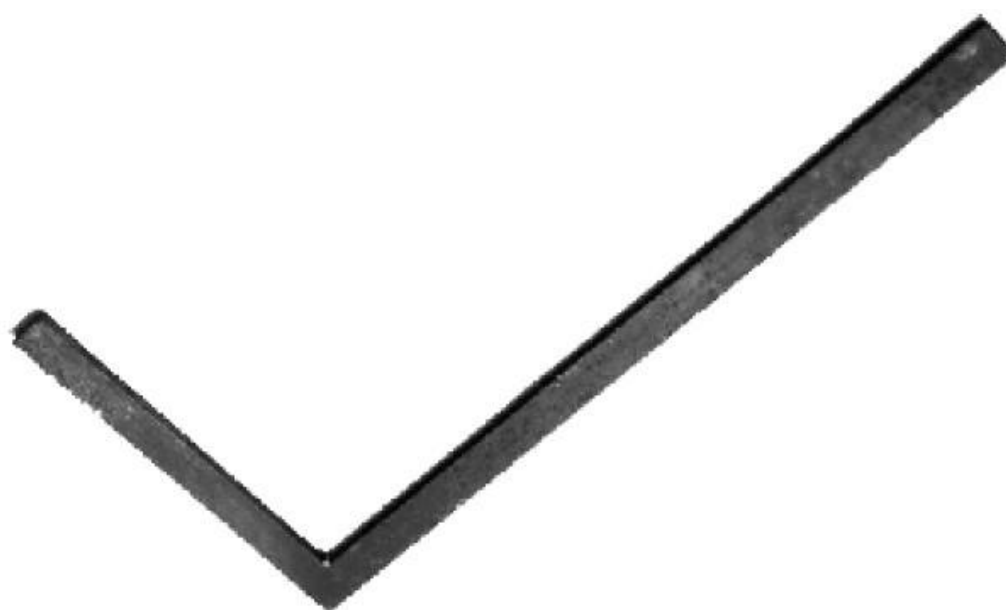
图 1-17 汉代铜矩尺(出土于陕西省延安市子长县桃园村。“矩”是画方和测方的工具，“矩尺”既可以画方，又可以测量长度)
