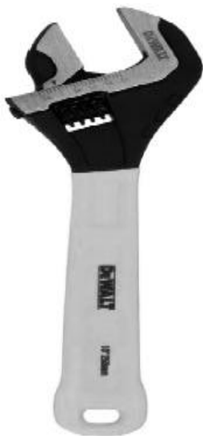
图 4-14 一支 10 英寸（约 250 毫米）型号的活动扳手
