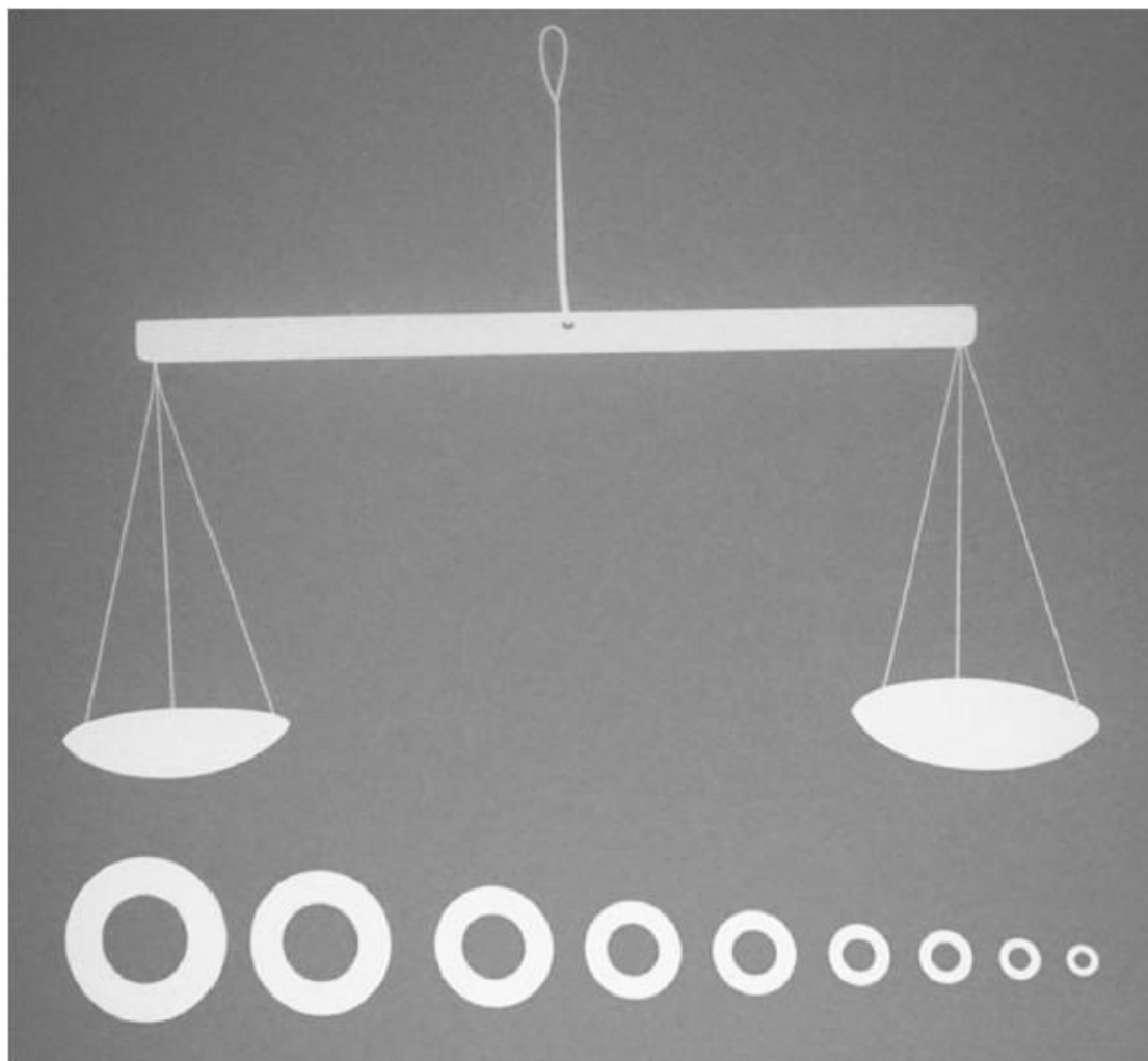
图 6-30 先秦时期的等臂天平与环形砝码（示意图）
